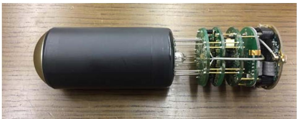
図 3.2 浜松ホトニクス製 R11920 PMT
