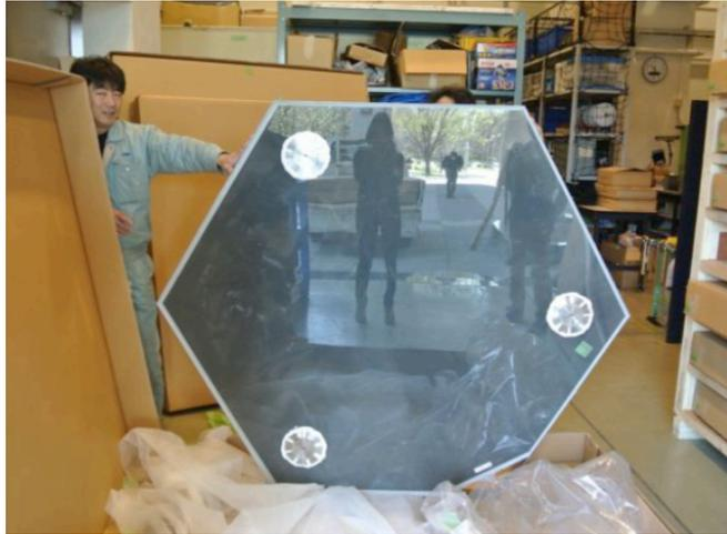
図 4.5: 分割鏡：裏面 [35]。アクチュエータを取り付けるためのパッドが取り付けられている。
