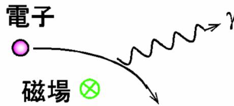
図 1.2: シンクロトロン放射の模式図。
