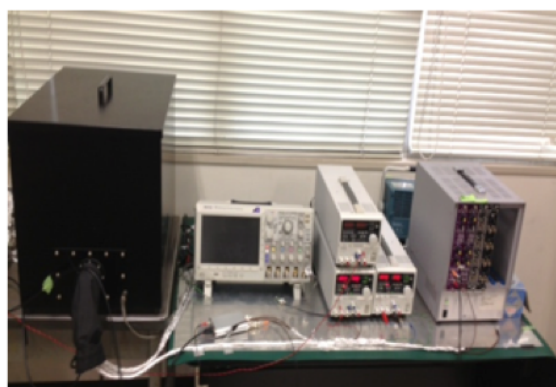
図 2.5 ゲッター改修前後のセットアップのダイアグラム (左) と、実際のセットアップの写真 (右)。オシロスコープで取得したデータを PC に保存している。ダイアグラム中のトリガーライン、電源系の赤線、さらにパルサーとパルスジェネレーター管の青線は同軸ケーブルであり、オシロスコープと PC 間の黒線は USB ケーブルである。またセットアップ中の光源、パルサー、パルスジェネレーター、オシロスコープ、Lee-Amp、電源の各サブセットは小山修士論文 (2012) と同様のものである。
