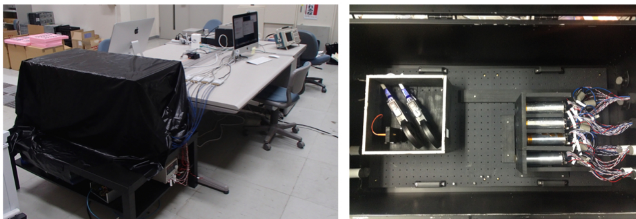
図 3.2 実際の試験系。左写真手前が暗箱。測定時は遮光のために暗幕を掛けている。右写真は暗箱中の様子。PMT は右側に 8 本置かれており、外部のパルサーがドライブして発光したレーザーダイオードの光を光ファイバーを通して暗箱中の光源用の箱の中で光る。測定時は、フィルターホイールを通した光以外を PMT へと照射しないために光源用の箱は密閉されている。
