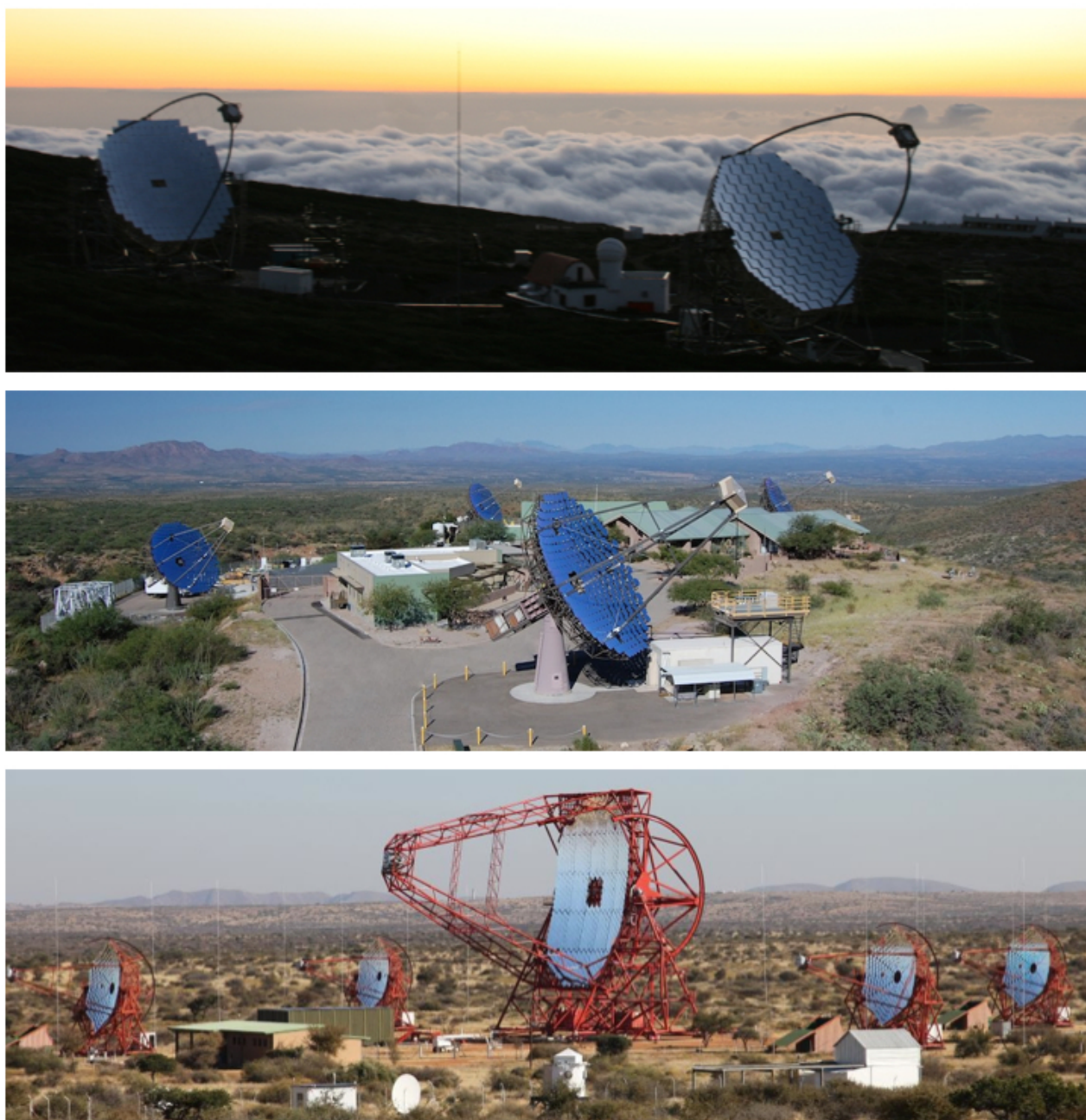
図 1.11 上段から MAGIC[40]、VERITAS[41]、H.E.S.S.[42] の写真。MAGIC は La Palma 島に建設され、Sum トリガーと呼ばれるトリガー方式を用いることでエネルギー閾値 25 GeV という低エネルギー閾値での観測が可能である。VERITAS は Arizona に建設され、視野 3.5' のカメラを複数台使用する事で 5.0' の視野を持つ。H.E.S.S. は 2002 年から 2004 年の間に Namibia に建設され、銀河面探索により多くの VHE ガンマ線源を検出するなどの成果を挙げている。近年では 28 m 口径の IACT を導入することで数十 GeV 帯域の観測を目指している。[7]。
