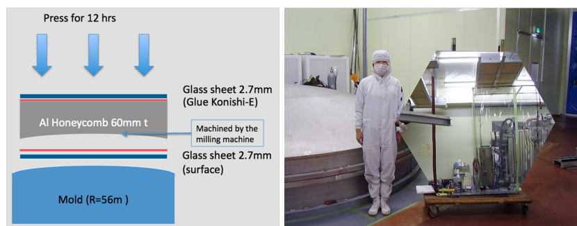
図 2.8: 左:分割鏡製作に用いた cold slump 法の略図。右:1.5 m 分割鏡の試作品
