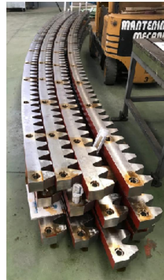
LST2用の望遠鏡土台（Az回転）部分
