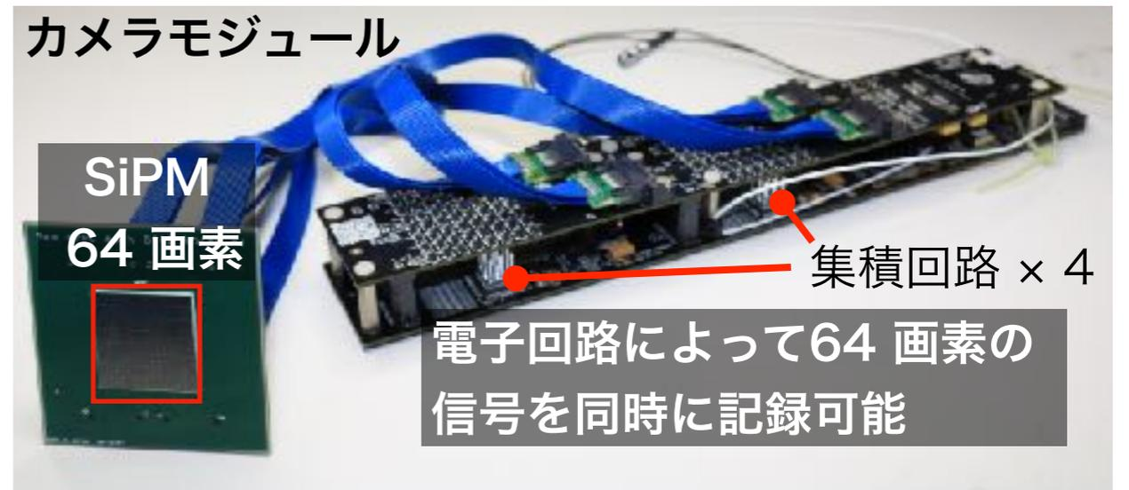
焦点面カメラはカメラモジュール 32 個で構成される
