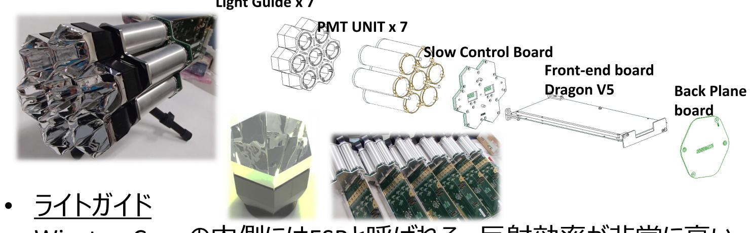
Winston Coneの内側にはESRと呼ばれる、反射効率が非常に高い 薄膜反射フィルムを接着しており、さらに追加コーティングにより観測対 象となる紫外線波長領域で集光効率95%以上を達成している。
