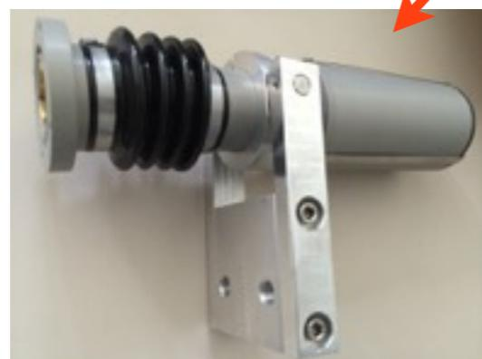
アクチュエータ (4 $\mu$ m精度で伸縮調整可能)
