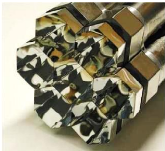
MAGIC望遠鏡 のライトガイド 反射材が貼って あり、内側は鏡 面になっている
