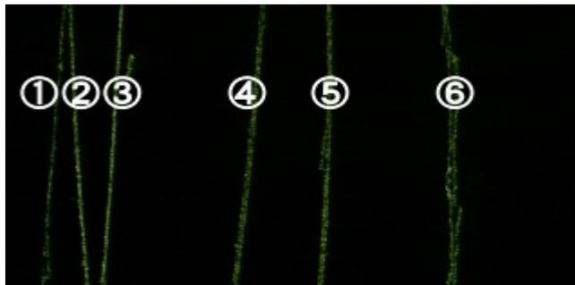
顕微鏡の透過光で見た鏡表面(真実幅1mm), 16 mm幅範囲内の傷の本数を数える
