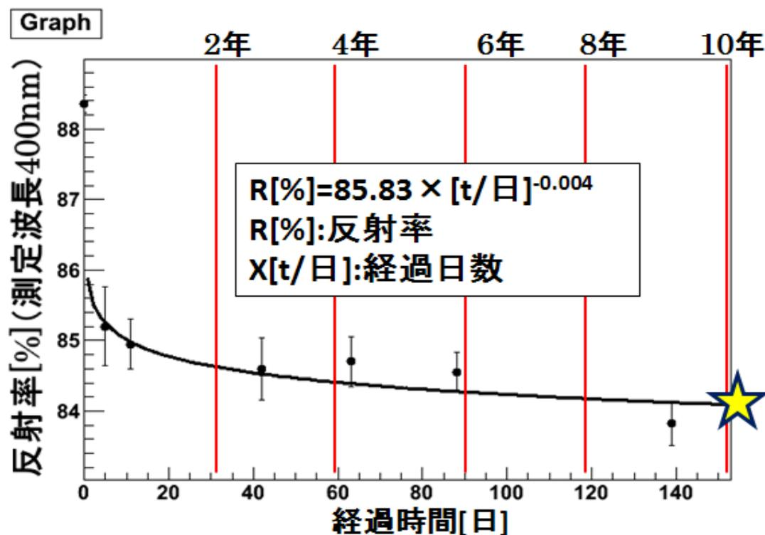
水戸の雨を用いた腐食加速試験結果
