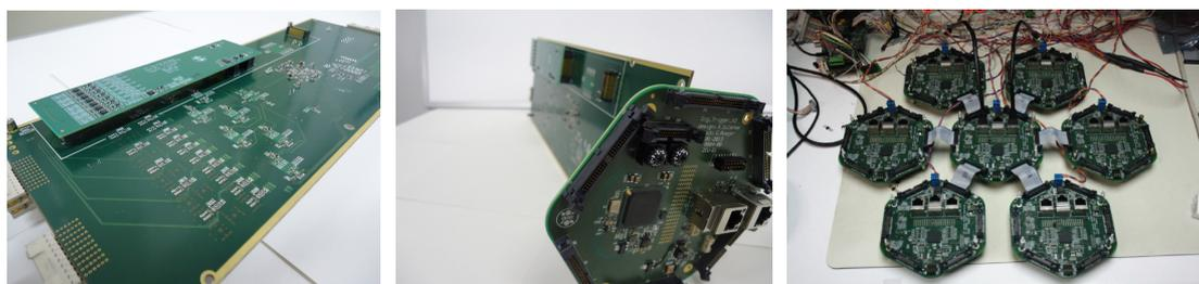
図 3.7.7 デジタルトリガー方式の 1 次トリガー生成用子基板(左)、バックプレーン(中)とアナログトリガー方式[5]の複数クラスターで接続されたバックプレーン (右)。
