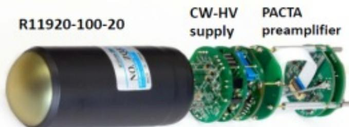
図 3.6.1 浜松ホトニクス社と共同開発した光電子増倍管 R11920-100-20. 高電圧回路と前置増幅回路が取り付けられている。ガンマ線観測用に最適化され、紫外線に対する量子効率が高い。
