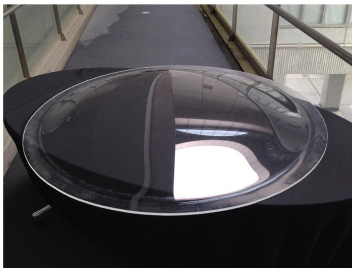
図 4.4.6 1.3 m 直径、8 mm 厚のアクリライト®を球型の加工したもの。中央部が 8 cm 程の高さを持つ。
