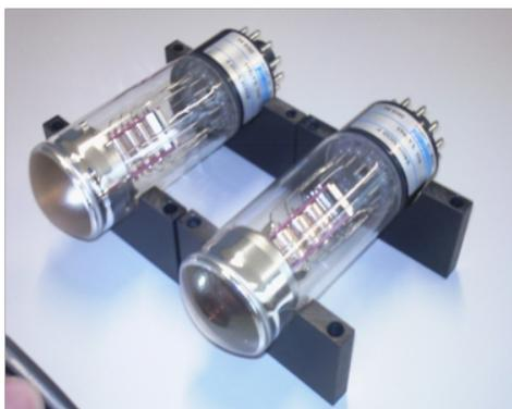
図 3.6.1 浜松ホトニクス社製 R8619 及び R9420 光電子増倍管
