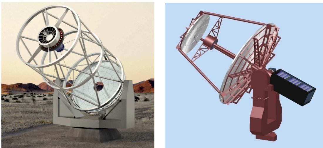
図 3.2.4 イタリアグループの設計 7 m 口径 Dual Mirror 望遠鏡 (左) と、イギリスグループ設計の 4 m 口径 Dual Mirror 望遠鏡 (右)。
