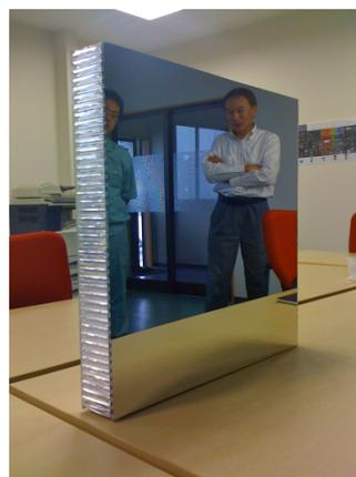
図 4.4.1 (左)Cold Slump 技術の概念図。(右) 三光精衡において Cold Slump 技術で試作した 50cm x 50cm 角型ミラー (曲率半径 30m、集光率 91%)。
