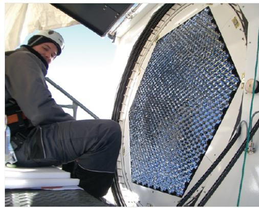
図 3.6.5 チェレンコフ望遠鏡焦点面カメラ(MAGIC-II)。高透過率入射窓でシールされる。CTA 大口径望遠鏡ではこの倍以上のカメラ径となる。
